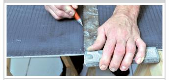
Markieren Sie die Schnittlinie mit einem Bleistift oder Filzstift mithilfe eines Winkel Messwerkzeug.
