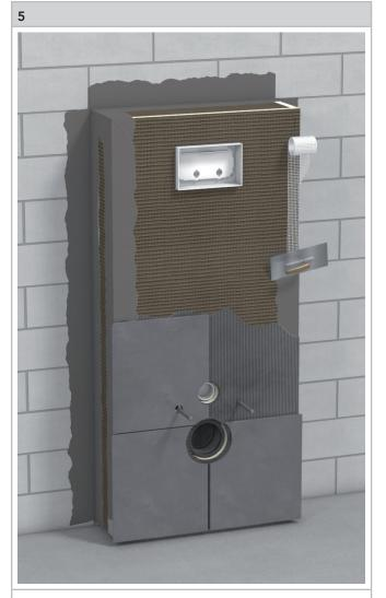
Tous les joints et raccords entre les éléments doivent être réalisés avec la bande d'étanchéité AR12C noyée dans le CERMICRYL.
