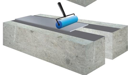
Bringen Sie das Abdeckband in der Mitte und entlang der Länge des CERMIBAND an (Breite entspricht der Breite der Fuge oder des Risses). Bringen Sie auch Klebeband an den Außenkanten an. Verteilen Sie dann das CERMIBAND ADH mit einem Spachtel oder einer Kelle auf der ersten Schicht CERMIBAND ADH und auf dem CERMIBAND. Entfernen Sie dann das gesamte Abdeckband.
